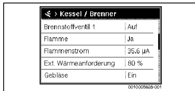
Bild 58 Ionisationsstrom (Flammenstrom) im Menü Monitoring
