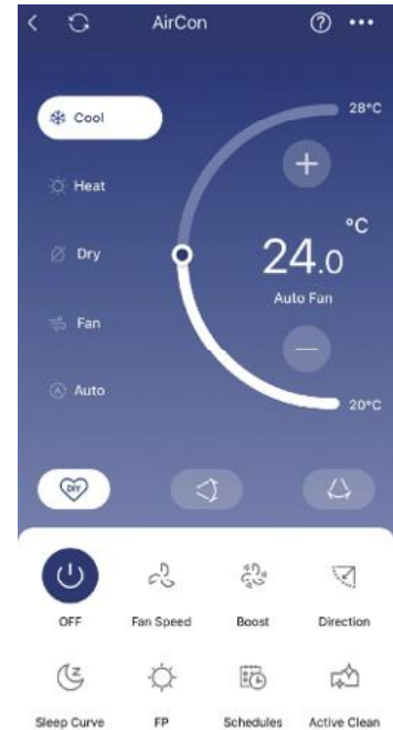
③ Somit kann der Benutzer den Ein-/Ausschaltstatus, den Betriebsmodus, die Temperatur, die Lüftergeschwindigkeit usw. der Klimaanlage steuern.
